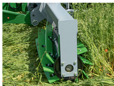
Tokie volai ir jų darbinės dalys naudojami rugiams ar kitiems tarpiniams augalams pakloti
