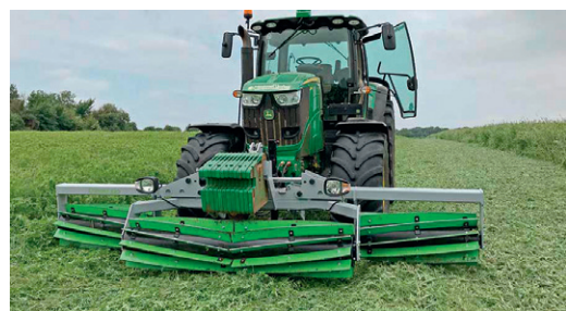
Tokie volai ir jų darbinės dalys naudojami rugiams ar kitiems tarpiniams augalams pakloti
